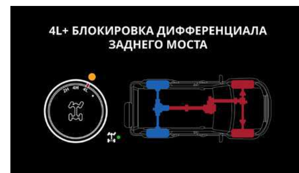
Отображение режимов работы трансмиссии
